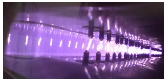
شکل ۸: دشارژ برافروخته در بین الکترودها و گاف جرقه [۱۱]
