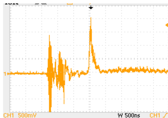
شکل ۷: شکل پالس لیزر
