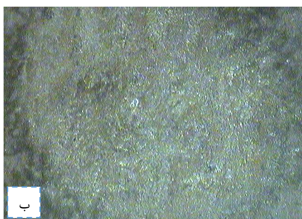
شکل ۳: مقایسه کیفی کندگی برای حالت الف) دوپالسی ب) تک پالس برای نمونه آلومینیوم (حالت موازی)
