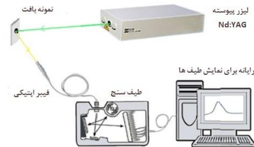
شکل ۱: طرحواره‌ی از سیستم آزمایشگاهی انجام طیف‌سنجی به روش فلوئورسانس القایی لیزری بر روی بافت سالم و سرطانی.
