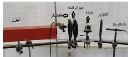
شکل ۲: تصویر از چیدمان آزمایشگاهی بیضی‌سنجی نول
