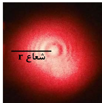
شکل ۶: الگوی میدان دور به شکل حاشیه‌های گرد بر روی صفحه‌ی بیم پروفایلر
