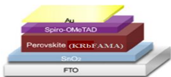
شکل ۱: ساختار دستگاه سلول خورشیدی پروسکایتی، KRbFAMA به عنوان یک لایه جاذب
