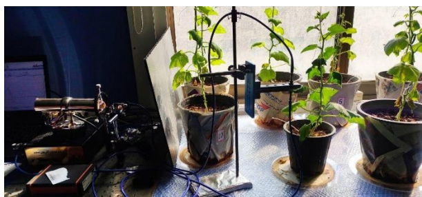
شکل ۳: چیدمان استفاده شده برای اندازه‌گیری و ثبت طیف‌ها.
