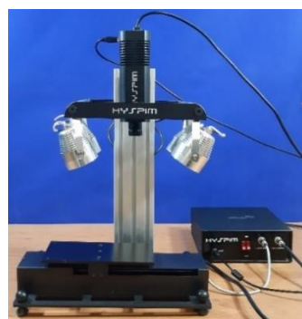
شکل ۱: تصویربردار فراطیفی همراه با اسکنر خطی.
