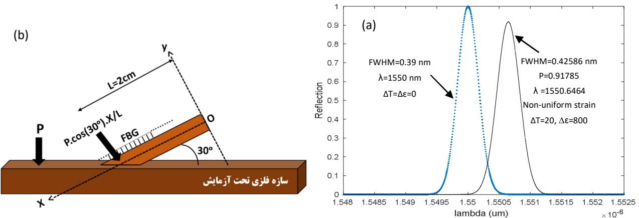
شکل ۱: a) نحوه تغییر پهنا و توان پیک بازتابی با اعمال کرنش  $\Delta\lambda=800$  nm و دمای  $20^\circ\text{C}$  و b) نحوه قرار گرفتن FBG و طرہ بر روی سازه نمونه
