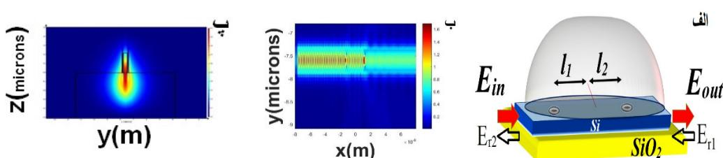
شکل ۱-الف) پیکربندی از حسگر ضریب شکست شامل موجبر اتوبوسی حفره دار . شدت میدان الکتریکی در ب) طول موجبر دندانه دار
