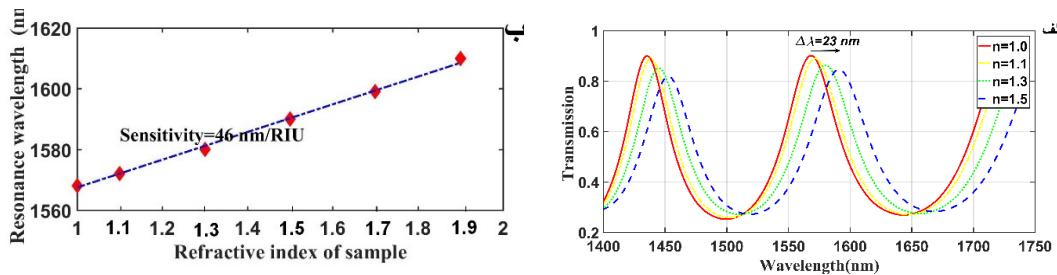
شکل ۲- (الف) میدان عبور بر حسب طول موج برای تشیدیدگر حفره دار برای اعمال شش ماده با ضریب شکستهای مختلف (ب) خط حسگری برای تشیدیدگر حفره دار
