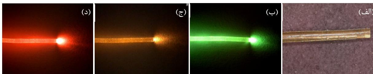
شکل ۳- (الف) تصاویر میکروسکوپی فیبر نوری، تصاویر میکروسکوپی هدایت نور در فیبرنوری پلیمری در طول موج، (ب)  $532\text{nm}$ , (ج)  $589\text{nm}$ , (د)  $650\text{nm}$ .
