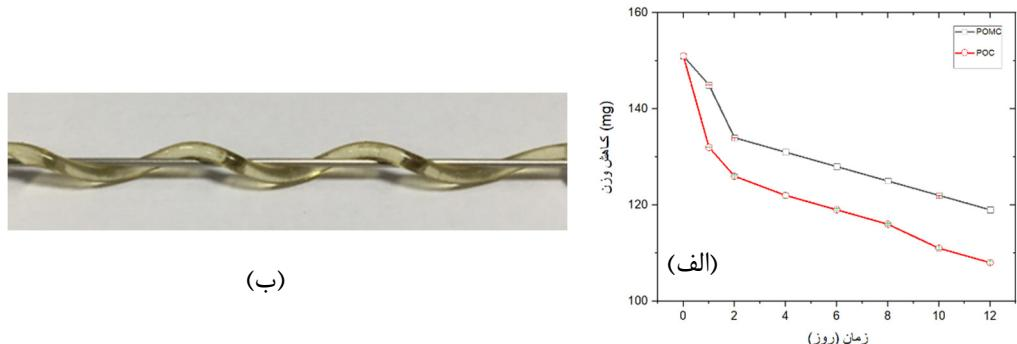
شکل ۲- (الف) نمودار تخریب پلیمرهای POMC و POC در ۱۲ روز، (ب) فیبرنوری پلیمری پیچانده شده در اطراف میله.
