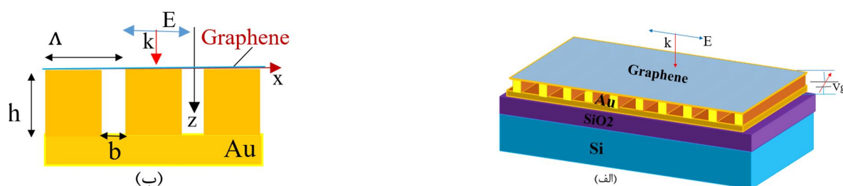
شکل ۱: (الف) نمای سه بعدی از آشکارساز نوری مبتنی بر گرافن، (ب) نمای برش دو بعدی از نانو توری و گرافن.
