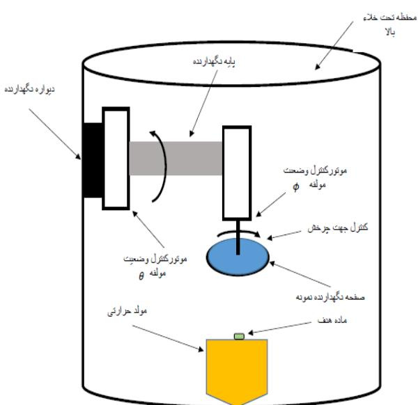
شکل ۱. طرح واره محفظه خلاء ماشین لایه‌نشان و اجزا سیستم GLAD
