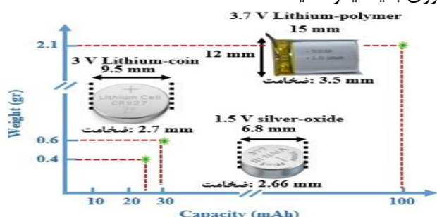
شکل ۳: مقایسه انواع باتری های مورد استفاده برای راه اندازی سیستمهای قابل حمل توسط موش صحرایی از نظر وزن باتری، ظرفیت انرژی و سایز باتری
