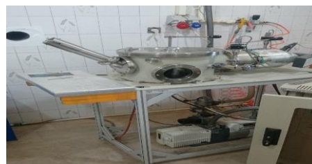
شکل ۱: تصویر دستگاه لایه نشانی PLD.
