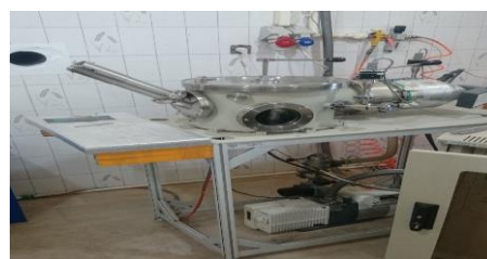
شکل ۱: تصویر دستگاه لایه نشانی PLD.
