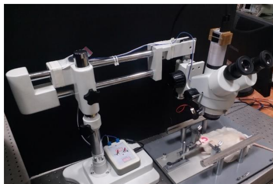
تصویر ۲: سیستم تصویربرداری کانتراست اسپکلی لیزری
