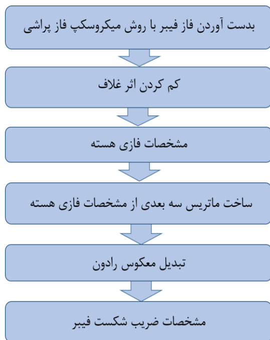
شکل ۱- روش بدست آوردن پروفایل ضریب شکست فیبر
