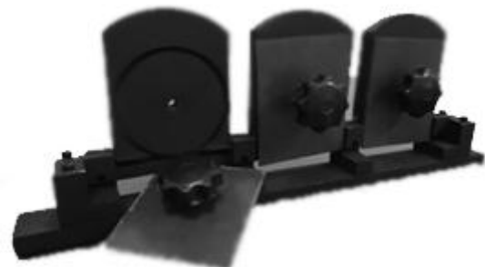
شکل ۸: دستگاه کنترل کننده قطبش فیبری مکانیکی ۳- صفحه ای ساخته شده.
