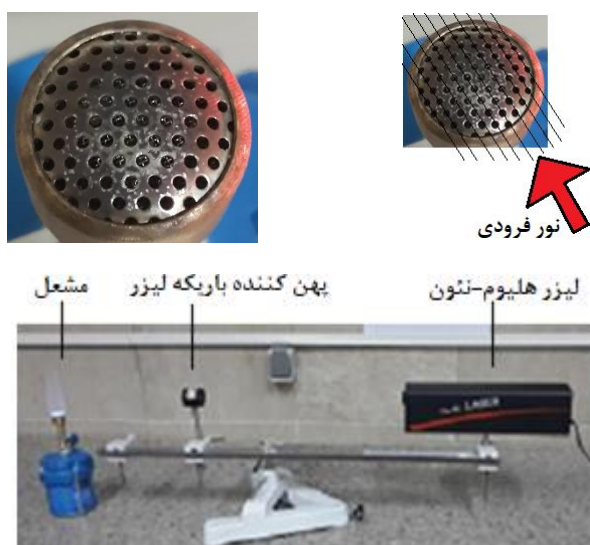
شکل ۱: (بالا) عکسی از سر مشعل که دارای منافذ متعدد است. (پایین) عکسی از چیدمان آزمایش برای بررسی انتشار نور لیزر هلیوم-نئون از یک دسته شعله گاز بوتان-پروپان.
