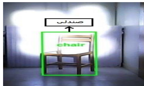
شکل ۴: در این جا تصویر صندلی شناسایی شده است ولی ال ای دی هایی که به صندلی نور می تابند خاموش نشده اند. ما به جای صندلی می توانیم از اشیاء دیگر مانند دوچرخه یا از حیوانات مانند سگ و گربه استفاده کنیم.
