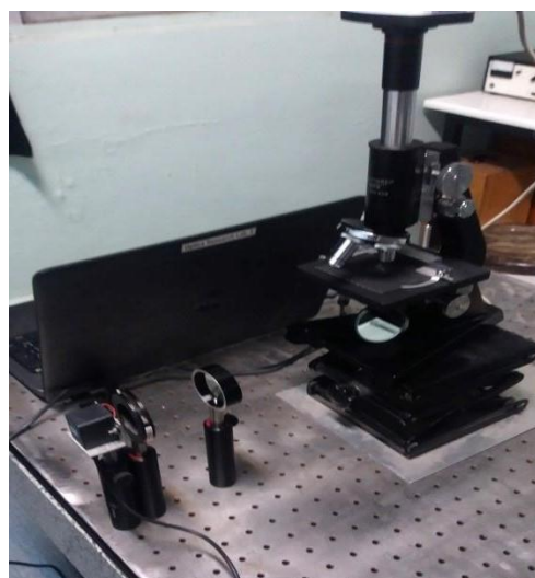
شکل ۲: چیدمان میکروسکوپی فازی به روش پراش فرنل
