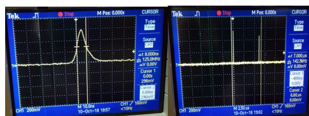
شکل ۹: پهنای پالس خروجی لیزر برای تک پالس (سمت راست) و دو پالس متوالی با فاصله ۷ میکروثانیه
