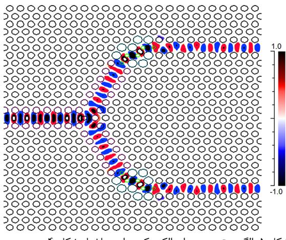
شکل ۵: الگوی توزیع میدان الکتریکی برای ساختار شکل ۴.
