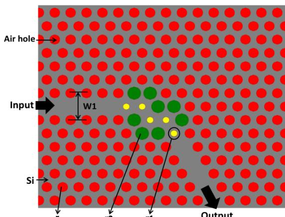
شکل ۲: خم موجبر پیشنهادی در ساختار مقسم توان.
