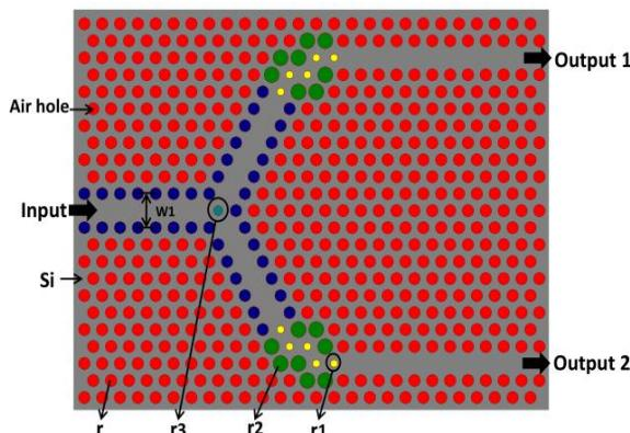
شکل ۴: ساختار پیشنهادی برای مقسم توان با خم ۶۰ درجه و اتصال Y شکل بکمک توزیق سیال نوری (حفره‌های آبی رنگ).
