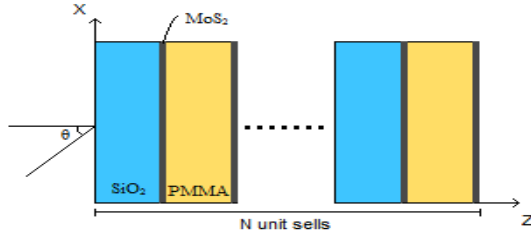
شکل ۱: ساختار بلور فوتونی یک بعدی حاوی مولبدین دی سولفاید.
