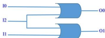
شکل ۱: نمودار مدار منطقی رمزگذار پیشنهادی
