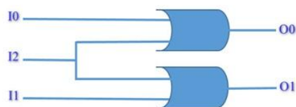
شکل ۱: نمودار مدار منطقی رمزگذار پیشنهادی
