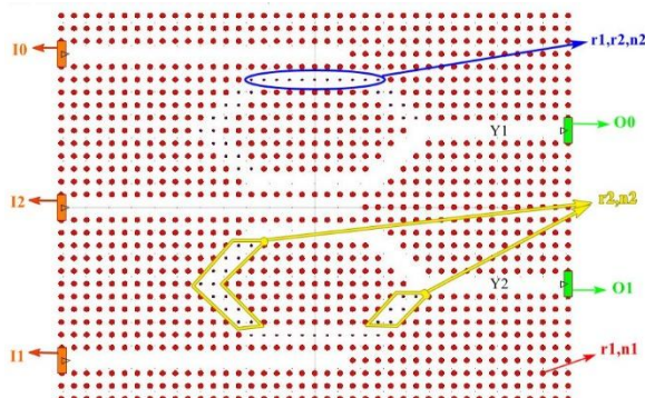
شکل ۲: ساختار بلور فوتونی رمزگذار تمام نوری
