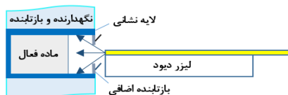
شکل ۳: طرحی از تیغه لیزر با لایه‌نشانی از سه طرف و روزنه دمش.
