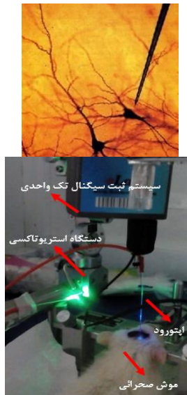
شکل ۲: چیدمان تحریک اپتوژنتیکی و پایش سیگنال عصبی با استفاده از ثبت سیگنال تک واحدی (سمت راست) و تصویر یک نمونه از قرارگیری الکترود در مجاورت یک سلول عصبی
