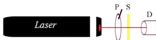
شکل ۱: چیدمان اپتیک برای سنجش چگالی نوری بافت تومورهای مغزی. (P) قطبشگر، (S) نمونه مورد آزمایش و (D) آشکارساز.
