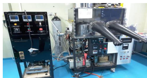
شکل ۷: دستگاه لایه نشانی تحت خلا در محیط گاز خنثی آرگون
