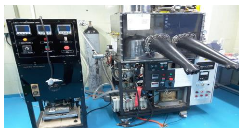
شکل ۷: دستگاه لایه نشانی تحت خلا در محیط گاز خنثی آرگون
