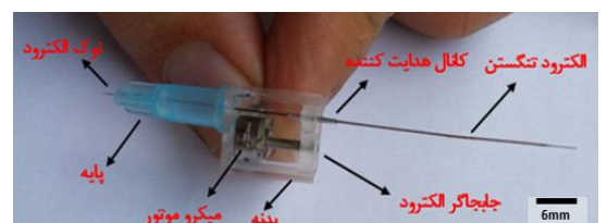
شکل ۳: تصویر میکرو جابه جاگر موتوردار ساخته شده در آزمایشگاه
