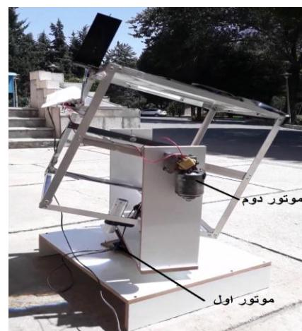
شکل ۲- ساختار مکانیکی ردیاب
