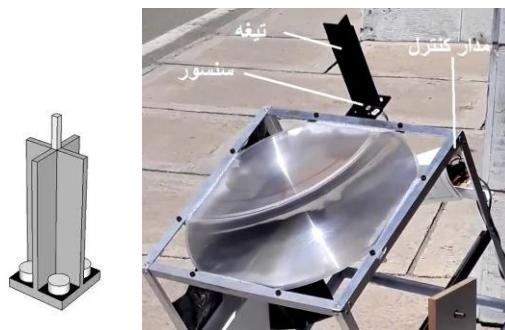
شکل ۱- مدار کنترل و حسگر سامانه ردیاب
