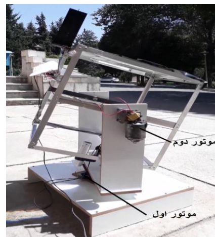
شکل ۲- ساختار مکانیکی ردیاب
