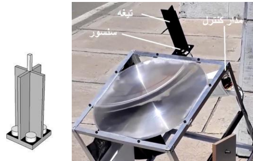
شکل ۱- مدار کنترل و حسگر سامانه ردیاب
