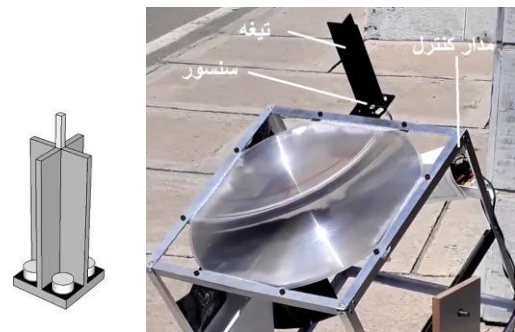
شکل ۱- مدار کنترل و حسگر سامانه ردیاب
