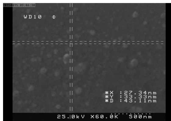
شکل ۱: تصویر SEM نانوذرات کلئیدی نقره بعد از تابش گاما
