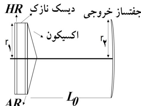
شکل ۱: پیکربندی رزوناتور دیسکی نازک با اکسیکون و لیزر دیسکی تعییه شده بر روی آن و جفت‌ساز خروجی را نشان می‌دهد.
