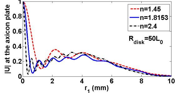
شکل ۲-ج : پروفایل عرضی باریکه در روی اکسیکون بر حسب شعاع دیسک ( $R_{disk} = 50L_0$ ) و جفت‌ساز خروجی تخت است.
