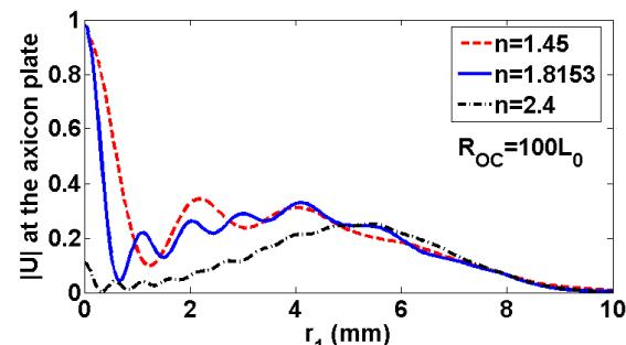
شکل ۳-۵: پروفایل عرضی باریکه در روی اکسیکون بر حسب شعاع جفت‌ساز خروجی ( $R_{OC} = 100L_0$ ) و دیسک تخت است.
