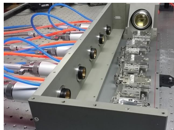
شکل ۷: نمایی از چیدمان ترکیب آرایه‌ای پرتوهای لیزر فیبری با استفاده از منشورهای راست‌گوشه قرار گرفته بر روی نگهدارنده‌هایی با ۵ درجه‌ی آزادی.
