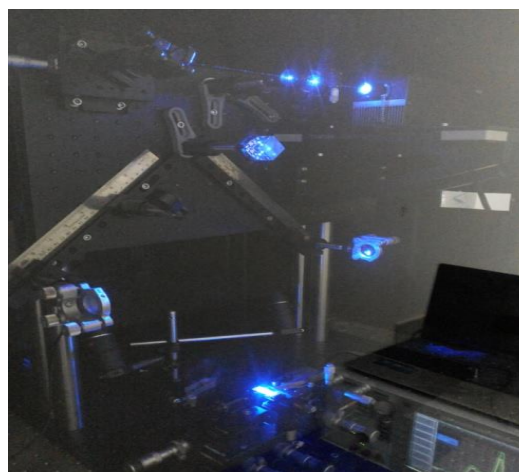
شکل ۳: تصویری از چیدمان تداخل دوباریکه ای در هنگام نوشتن توری براگ با لیزر آبی ۴۷۳ نانومتر
