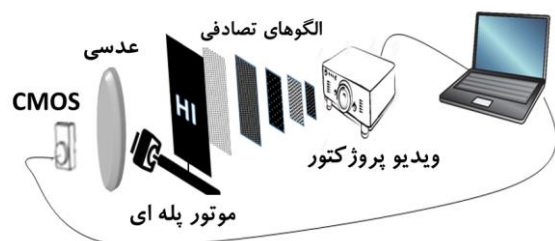
شکل ۱: چیدمان تصویربرداری شبه گونه محاسباتی با استفاده از دستگاه ویدئو پروژکتور
