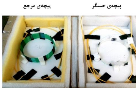
شکل ۱: تصویری شماتیک از پیچیده‌های حسگر فیبر نوری ساخته شده
