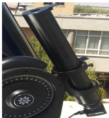
شکل ۳: دستگاه شیدسنج خورشیدی نصب شده روی پایه تلسکوپ.
